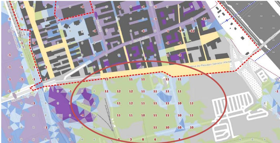
**Figure n° 20 – Surélévation calculée à l'amont de la rue Salvador Allende sur la ZAC Seine Gare Vitry en l'absence de mesures compensatoires**
